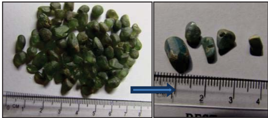
රූපය 08. ඔක්සිහරණ තත්ව යටතේ 1750°C දක්වා තාපනය කළ කොළ පැහැති ජාගුන් වල වර්ණය ලා නිල් පැහැයට හැරීම.
