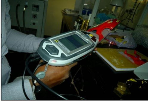
உருப்படம் .8.6: உலாவி நகர்த்தக்கூடிய XRF கருவியைப் பயன்படுத்தும் மாதிரிப் பகுப்பாய்வு
